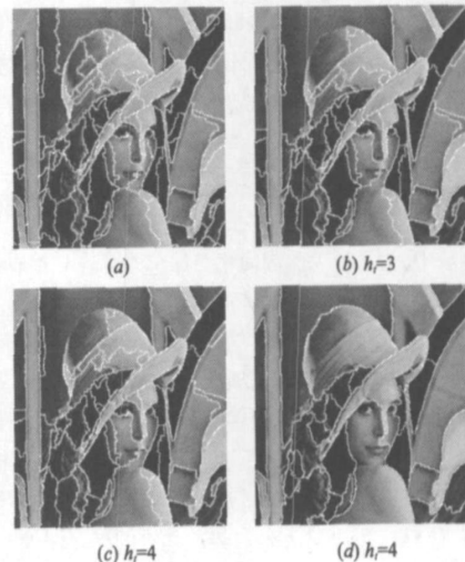
图 4 (a)简化之后的图像上直接进行 Watershed 分割的结果 (b)采用阈值 h_t=3 的 H-minima 技术后的分割情况 (c) 阈值 h_t=4 的分割情况;(d)H-minima 技术应用到文中提出的新算法的分割结果
